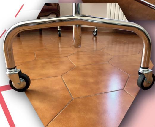
È realizzato in ferro grezzo decapato tramite un processo chimico di dissoluzione e successivamente vengono effettuate delle cromature di nichelatura per renderlo più resistente all'ossidazione e alla ruggine. Ha una capacità di peso di circa 70-85 kg. L'asta orizzontale ha un'estensione di 35cm per lato.
